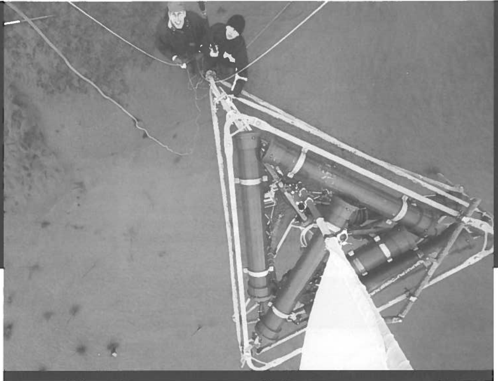
Zelfreflectie op het vakgebied vanuit een vogelvluchtperspectief: Maarten Kleinhans (links) en Pim van Santen (rechts) bij hun meetframe op de delta van de rivier de Teign, Zuid-Engeland. Het fototoestel hangt aan een hengel en wordt in deze opstelling gebruikt voor stereofoto's van de onderwater-duinen op de delta.
