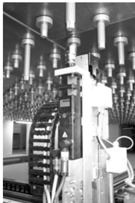
De motor die de staven aandrijft.
