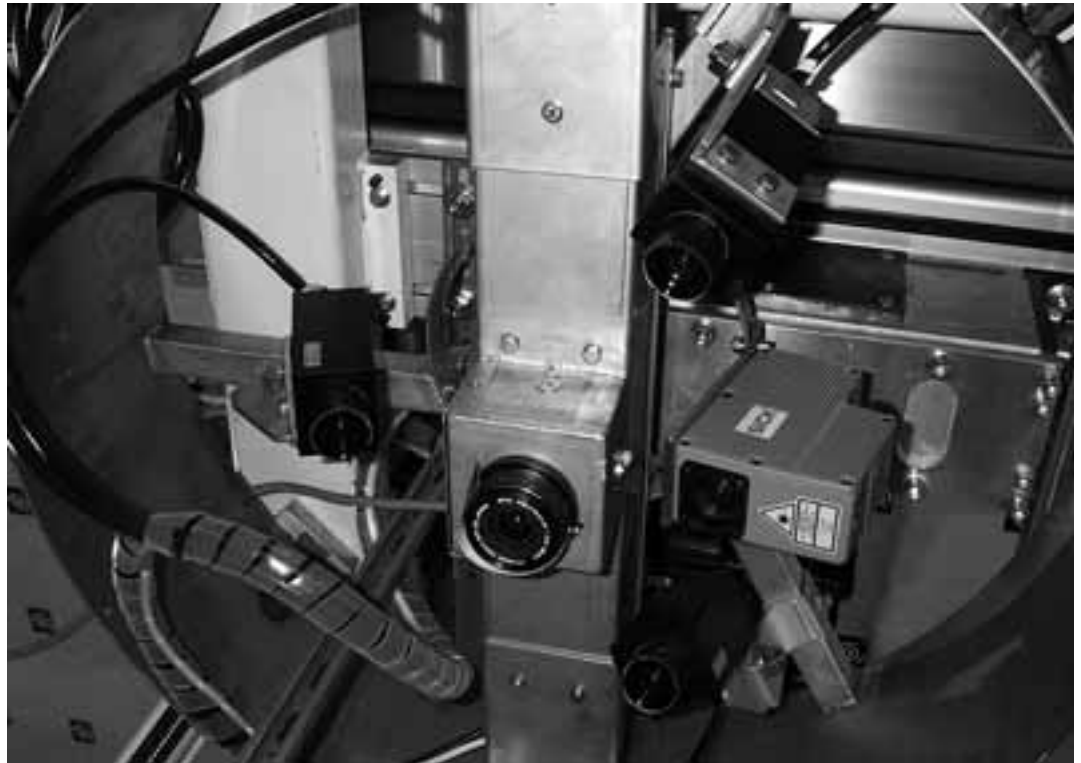
Het systeem van camera's en flitser voor hoogtemetingen.
