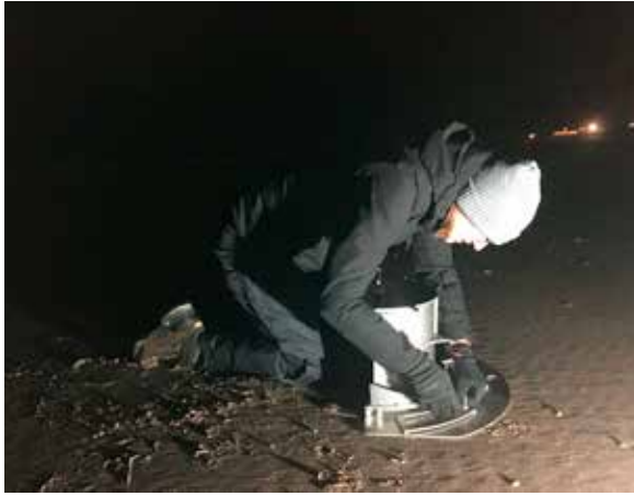
De meeste gunstige waterstand en windcondities trekken zich niets aan van normale werktijden: veldwerk met de zandschraper in de nacht.
