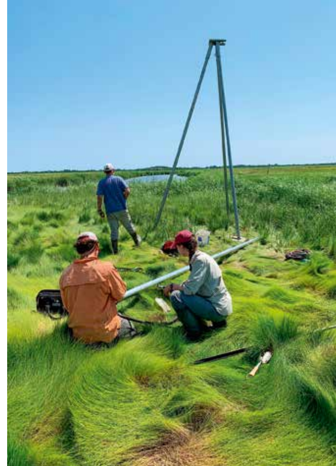
Boren met een vibrocorer. Al trillend worden zand, klei en veen bemonsterd.
