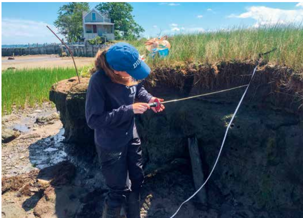
Bepaling van schuifsterkte in de kweldersedimenten van Massachusetts.
