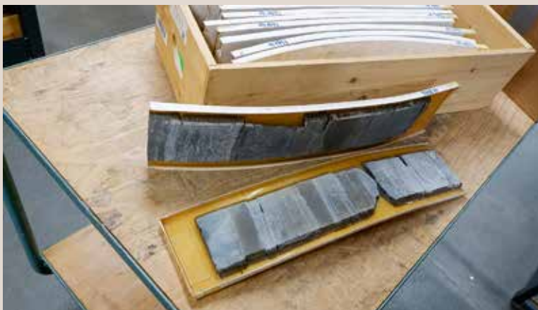
Foto 9 Kromgetrokken resinslabs. Komt het meest voor als het ingeharste deel uit klei bestaat. Gevolg van Clay swelling terwijl het karton en de kunsthars niet meegeven?
