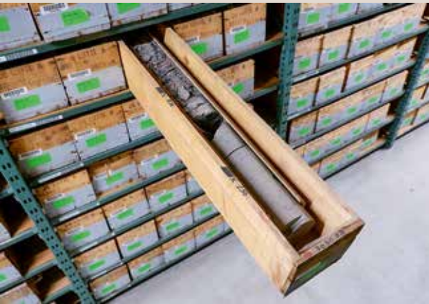
Foto 5 Geschaafd houten kist met een 'whole core', zelfs nog deels in de core sleeve.
