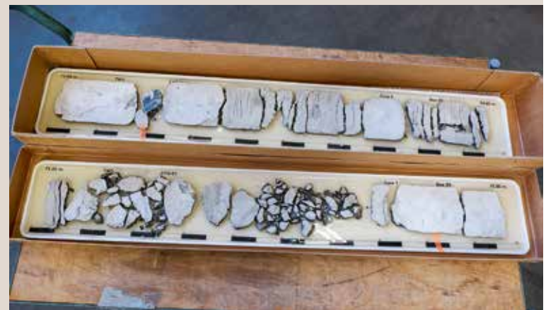
Foto 10 De moderne manier van het maken van 'resin slabs' in sterke plastic trays en met een kleurloze niet plakkerige kunsthars.
