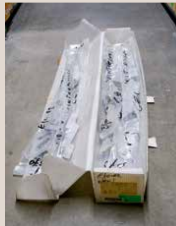
Foto 6 Plastic kerndoos met een heel aantal 'representatieve' slabbed stukken kern (1/4 snede). De slabs zijn in plastic sleeves gepakt die strak dicht geniet worden om de stukken kern in de goede volgorde te houden.
