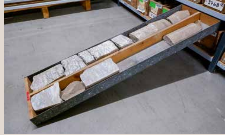
Foto 4 Een 1/3 snede van een anhydrietkern in een verzinkte ijzeren bak.
