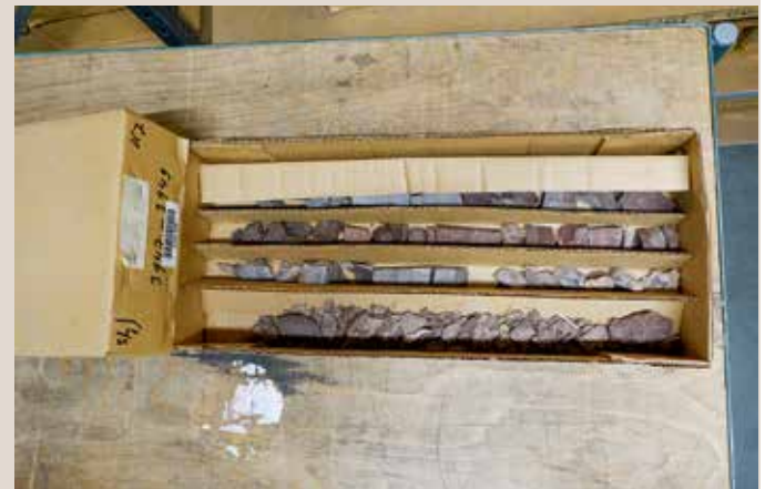
Foto 7 Schoenendoosformaat kernverpakking met totaal twee meter kernlengte van de helft van een 1/4 snede, eigenlijk flinters. Volgorde van de stukjes is wat dubieus. Vergt veel van je puzzelskills om hier binnen de twee meter een betrouwbare faciesvolgorde van te maken.
