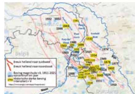
Aardbevingen in de Roerdalslenk met een magnitude groter dan 3 op de schaal van Richter 1911-2021 (blauwe cirkels). Aardbevingen met Intensiteit groter dan V gelabeld met jaartal; de jaartallen in geel zijn historische bevingen. Gegevens van Houtgast, de Geologische Dienst Nordrhein-Westfalen, de 2010b EKDAG-erweiterter Ahorner-Katalog en de meest recente aardbevingscatalogus van Duitsland.
