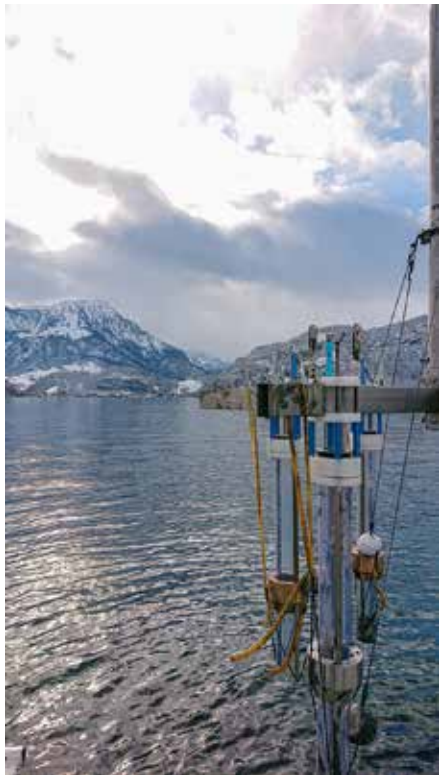
Een multicore-sampler, waarmee gelijktijdig meerdere sedimentkernen van de meerbodem gehaald kunnen worden.
