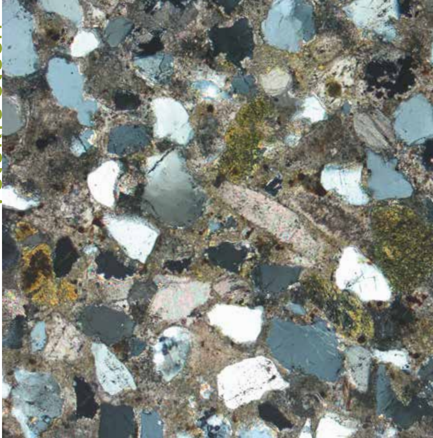
Microscopische opname van Dülmener kalkzandsteen (kruislings gepolariseerd licht).
