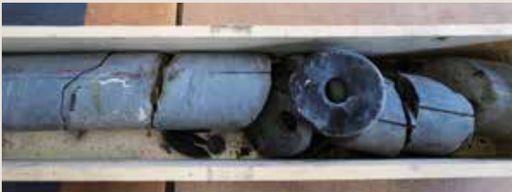
Fig. 7 Foto van kist zestien van kern twee. Hier is de dichte gelamineerde klei te zien met schelpfragmenten en heel dunne silt lamina. Duidelijk te zien is het gat waar de verticale kernplug is genomen in de klei. Foto: André Slupik
