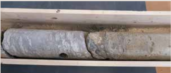
Fig. 6 Het interval van kern een, kist zeven waarin de overgang te zien is van een onregelmatig gelamineerde, gebioturbeerde kleiige zandsteen naar een homogene schone zandsteen. Op de overgang zijn grove componenten te zien waaronder grote schelpfragmenten en concreties. Foto: André Slupik
