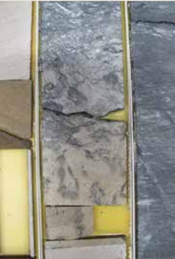
Fig. 5 Het interval uit de kern van Q13-9 zoals eerder in deze serie columns (Geo. brief 2, 2022) laten zien. De Base Cretaceous Unconformity gekenmerkt door een ‘basaal conglomeraat’ van de Vlieland Zandsteen Formatie boven een schone zandsteen van de Nieuwerkerk Formatie vol met vertical graafgangen of borings ook wel informeel de Amstel Zandsteen genoemd naar het Amstel olieveld. Foto: André Slupik
