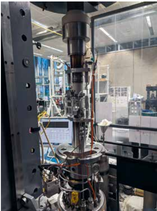
Putcement, klaar voor de test in triaxial drukapparaat in het lab in Delft, in het CEMENTTEGRITY-project.
