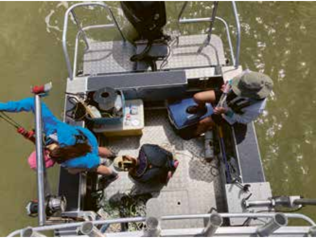
Bovenaanzicht van waterkwaliteitsbemonstering. Links worden diepteprofielen genomen van zoutgehalte en turbiditeit. Midden (ik) en rechts worden er watersamples gefilterd.
