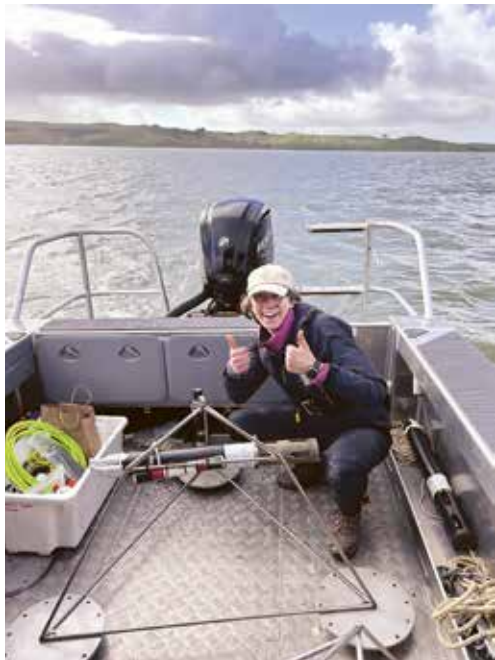
Foto vanaf de Oruawharo rivierarm (Kaipara Harbour) waar ik achter een CTD-frame sta die hierna het water ingaat. Hiermee monitor ik zoutgehalte, chlorophyll-a en turbiditeit over de periode van twee weken.
