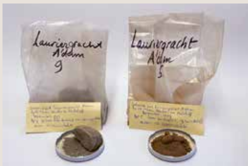
Fig. 4. Twee uitgepakte monsterzakjes van de boring Lauriergracht met een korte beschrijving. A No 5 Leem ter diepte 19,5-22 Ned El; B No 9, Grauwe klei ter diepte van 40,5 – 41,5 Ned El. Foto: André Slupik
