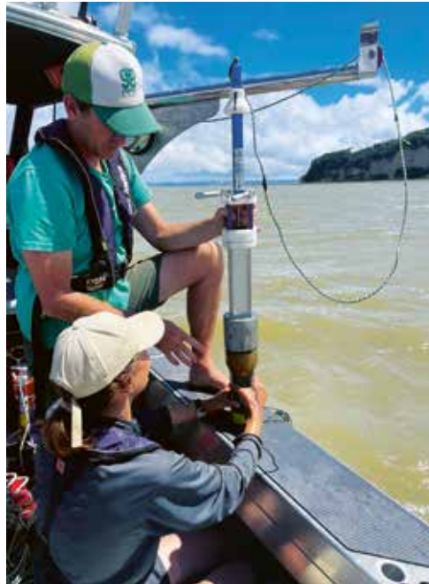
Foto vanaf de Hoteo rivierarm, met Moturemu Eiland op de achtergrond. We hebben net een sediment sample opgehaald met behulp van een precision corer. Deze samples gebruiken we om sedimenteigenschappen te bepalen.
