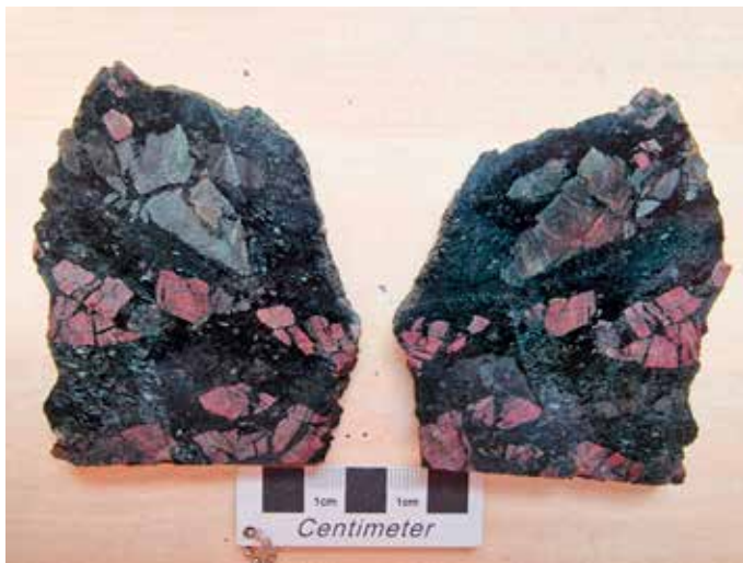
Fig. 2 Doorgezaagd stuk gesteente van de Olserum-Djupedal REE-mineralisatie in Zuidoost-Zweden. De ertsmineralen zijn xenotiem (roze-rood) en monaziet (geel-wit) in een donkere grondmassa van biotiet (zwart).
