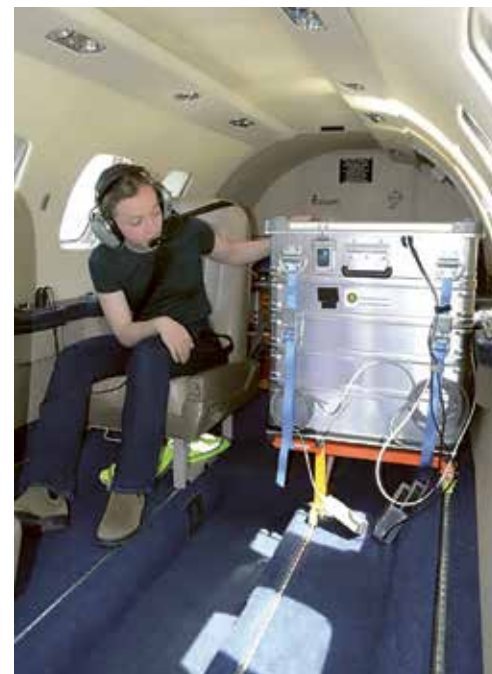
Fig. 7. Experimenteren met puinstromen onder verschillende zwaartekrachten tijdens een paraboolvlucht. Vlucht werd uitgevoerd in de PH-LAB, een Cessna Citation II van de TU Delft. In de zilverkleurige NATO-kist zit een ronddraaiende trommel waarin puinstromen in het klein over een oneindige helling (de binnenkant van de ronddraaiende trommel) kunnen stromen.
