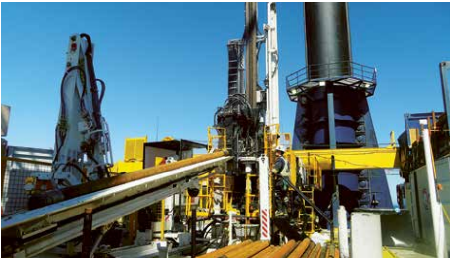
De boorinstallatie op de L/B Robert, waar de sedimentkernen voor het eerst het dek bereiken. Foto: Andrea Vale/ECORD:IODP3_NSF
