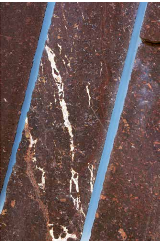
Fig. 3. Porfierische trachietlava uit de Boven-Carboon Step Graben Formatie in een tien centimeter brede kern uit boorput F04-02-A (offshore, Dutch Central Graben). Frontispiece van hoofdstuk 11.
