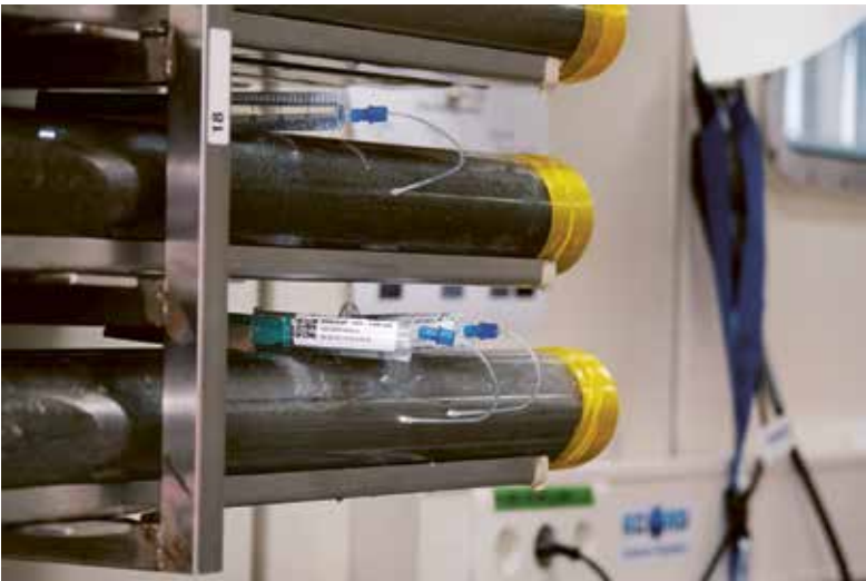
Extractie van poriewater uit de mariene sedimenten door middel van Rhizon sampling. Foto: Ellie Miller/ECORD:IODP3_NSF
