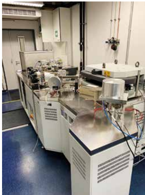
Het nieuwe ^4\text{He}/^3\text{He} -laboratorium in Potsdam. Op de voorgrond de massaspectrometer zelf, in het midden de preparatielijn waar het helium van andere gassen gescheiden wordt, en op de achtergrond, in de beschermende metalen doos, de laser die gebruikt wordt om de mineralen stapsgewijs op te warmen.
